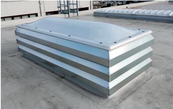
Basamento per la ventilazione continua di facile montaggio grazie alla dettagliata progettazione in 3D, composto da alette sagomate a Z da fissare a elemento di struttura, il tutto da installare su sottostante basamento impermeabilizzato. Dimensioni e finiture personalizzabili.
